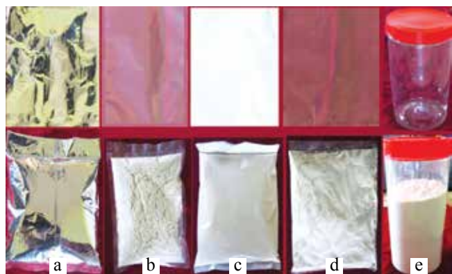
a) Aluminium pouch b) EVOH c) LDPE d) PP e) PET jar
